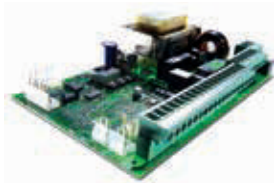
Плата управления 624 BLD (встроена в привод)
