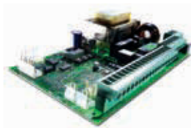
Плата управления 624 BLD (встроена в привод)
