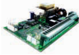
Плата управления 624 BLD (встроена в привод)
