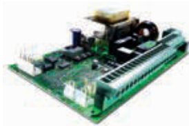
Плата управления 624 BLD (встроена в привод)
