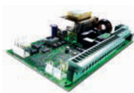
Плата управления 624 BLD (встроена в привод)
